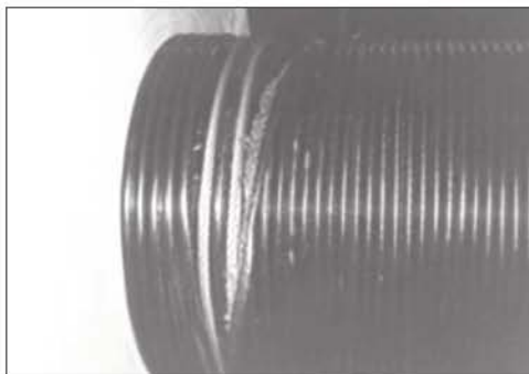
Повреждение оплетки в результате заклинивания и перекрещивания кабеля
