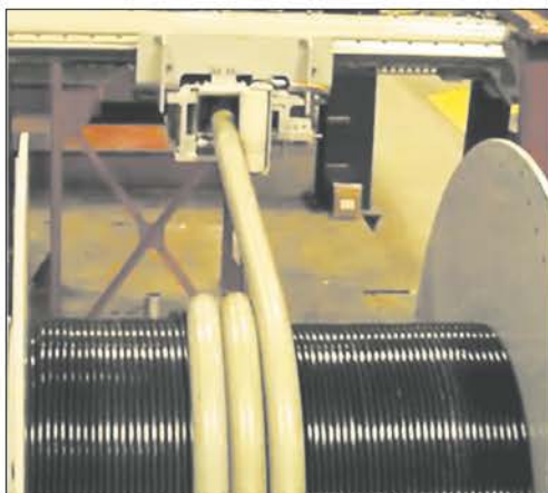
Функционирование намотчика при переходе от намотки троса к намотке конусообразного сегмента, являющегося промежуточным элементом между тросом и антенной
