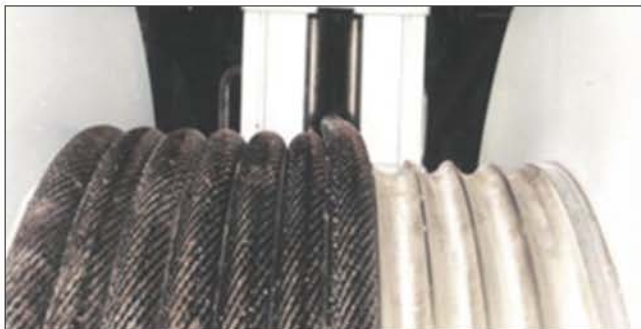
Намотка нескольких слоев троса при использовании параллельных желобков
