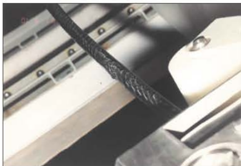
Повреждение оплетки кабеля направляющим валиком
