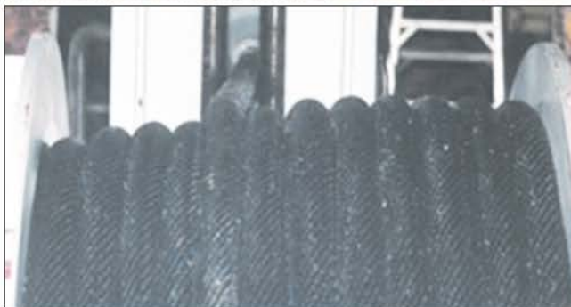
Параллельные пазы вьюшки для первого слоя витков (сверху) в сравнении с седьмым, намотанным уже на желобки, образованные витками предыдущих слоев
