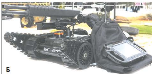
Боевое ружье QBS 09: общий вид (А); в составе вооружения дистанционно управляемой машины UGV (Б)
