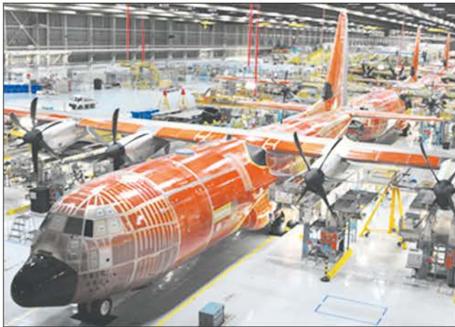
Сборка самолетов C-130J на заводе в г. Мариетта (штат Джорджия)
